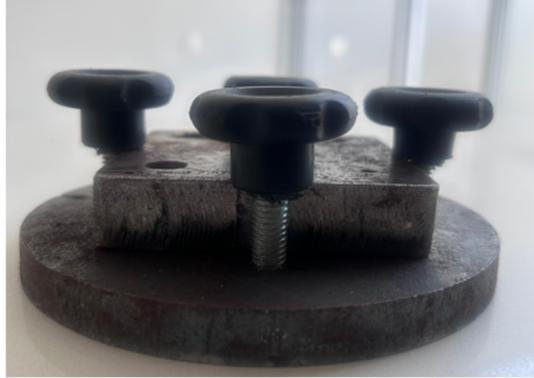
Figura 14 – Célula de compactação (vista lateral) – Fonte: O autor.
