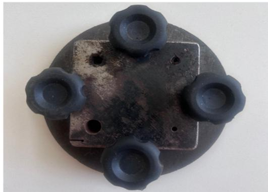
Figura 15 – Célula de compactação (vista superior) – Fonte: O autor.
