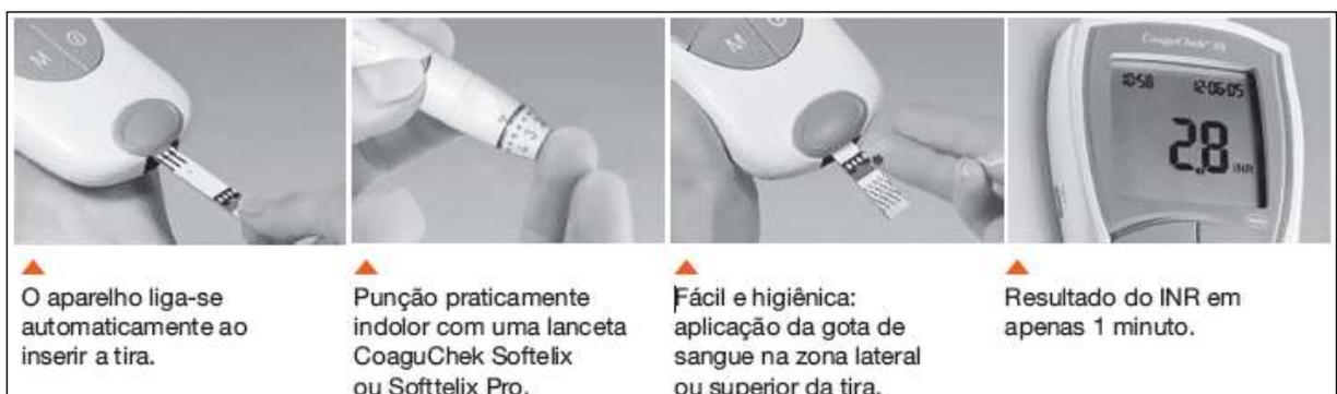
**Quadro 1** : Sistema portátil CoaguChek® XS Plus, para a obtenção da RNI em sangue capilar. (Fonte modificada: ANDRADE, 2014).
