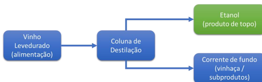
Figura 2.1 – Fluxo simplificado do processo de destilação para obtenção de etanol
