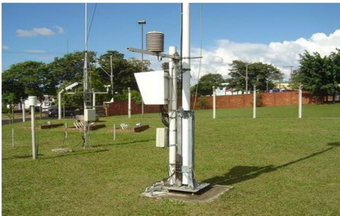
Figura 15 – Estação meteorológica automática de Uberlândia.
