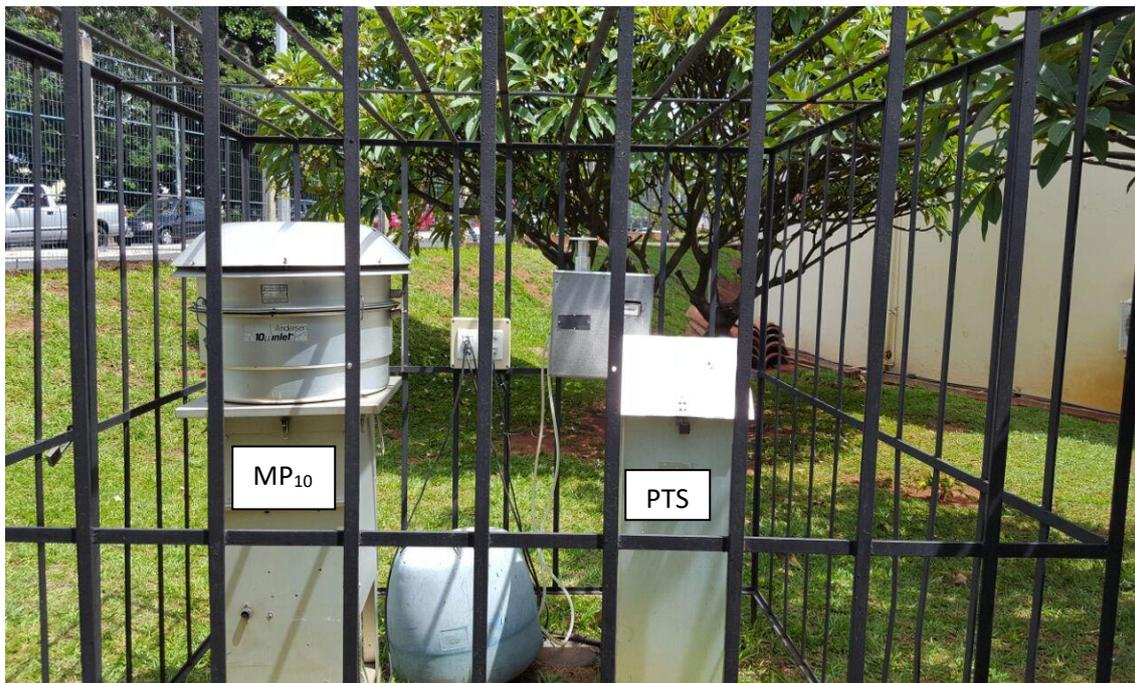
Figura 6 –Foto do Ponto de Amostragem 1 AGV-PTS; AGV MP<sub>10</sub>.
