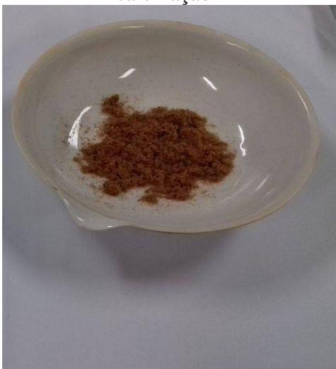
Na etapa de ativação química foi utilizado Cloreto de zinco (18,4 mol/L). A reação de ativação foi realizada conforme a metodologia descrita por Schettino Jr. (2004) utilizando a proporção: carvão para massa da solução: de 1:3 (m/m). A solução foi aspergida sobre o bagaço calcinado. Posteriormente a mistura foi mantida em repouso durante 1 h.
