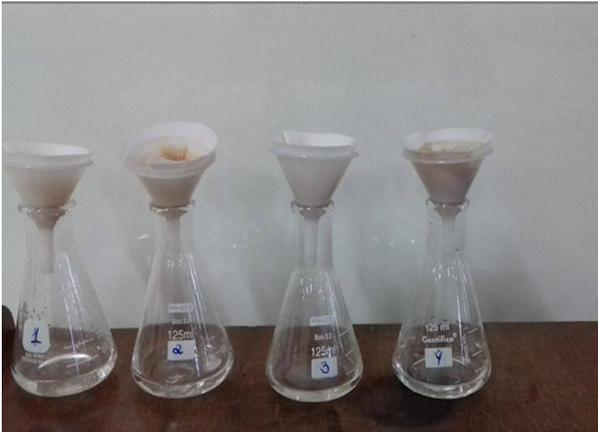
As soluções obtidas foram analisadas para determinar a adsorção de chumbo pelo carvão ativado. Para análise da adsorção foi utilizado o equipamento adsorção atômica de marca Varian. A leitura foi realizada no comprimento de onda de 283,3 nm.
