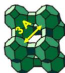
Figura 3 - Zeólito Tipo 3A – potasso-aluminosilicato.
