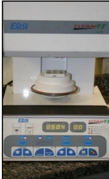
**Figura 9.** Simulação de queima da cerâmica de cobertura na subestrutura à base de di-silicato de lítio
