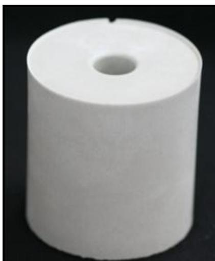
**Figura 3.** Anel de revestimento após a presa do material.
