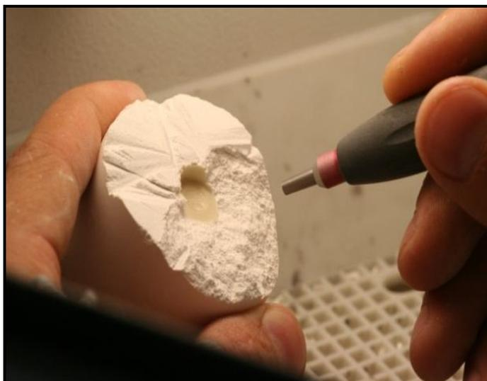
**Figura 7.** Remoção do revestimento com jateamento de óxido de alumínio com pressão de 4 bar.
