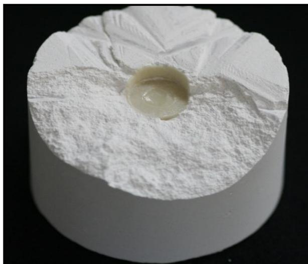
**Figura 6.** Vista do anel de revestimento após corte e exposição do botão de prensagem.
