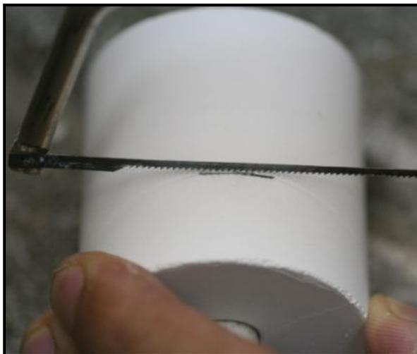
**Figura 5.** Corte do anel de revestimento após resfriamento
