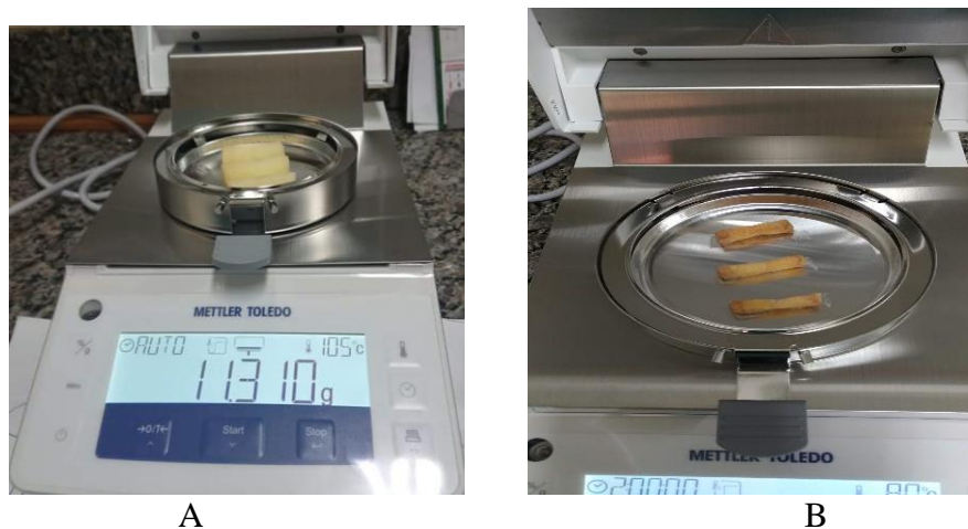
Figura 7 – Analisador de Umidade, (A) amostra com umidade e (B) amostra seca.
