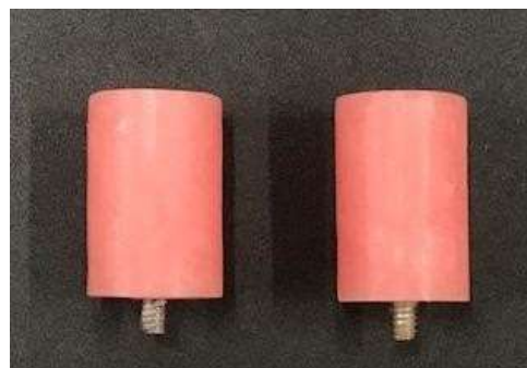
Figura 4. Espécimes confeccionados para análise da força adesiva. Fonte: COSTA et al. (2019).
