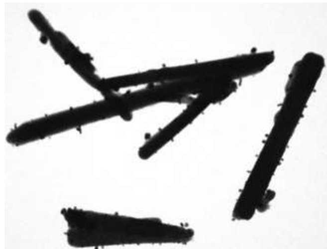
Figura 6. Microscopia eletrônica de transmissão do vanadato de prata nanoestruturado
