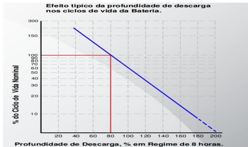
Figura 03: Ciclo por profundidade de descarga, bateria tracionária. Disponível em: https://docplayer.com.br/8765881-Vida-util-de-baterias-tracionarias.html
