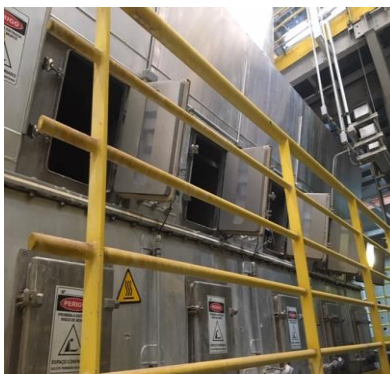
FIGURA 4 - Leito fluidizado industrial constituído por multicâmaras lateral de acesso.
