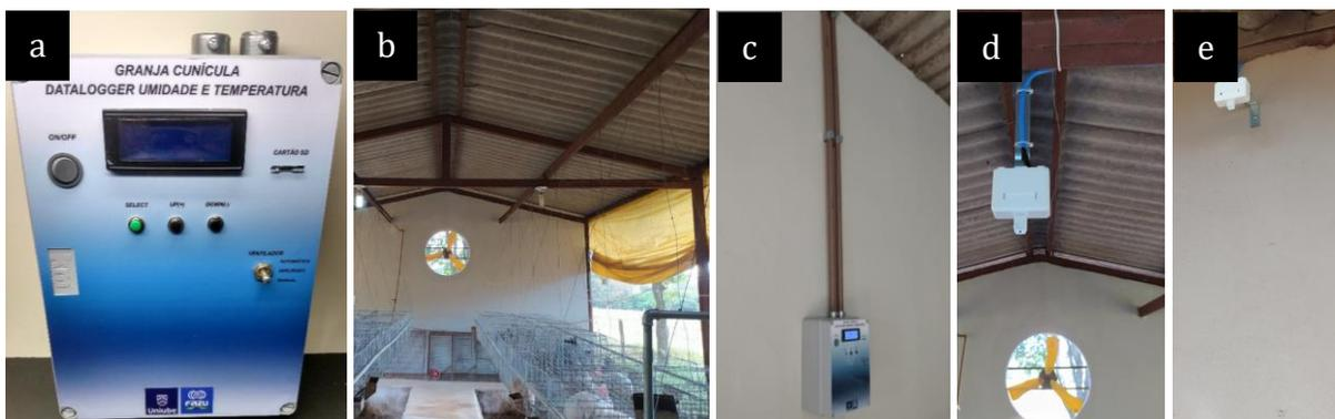
**Figura 5** – Painel de controle com componentes do sistema instalados no setor de cunicultura (a) Painel vista frontal (b) Granja cunícula (c) Painel de controle instalado (d,e) Sensores DHT22
