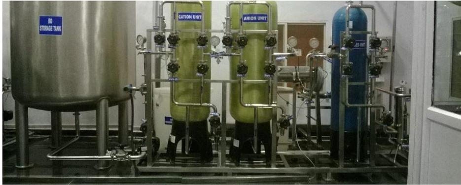
**Figura 5:** Desmineralizador de processo industrial.
