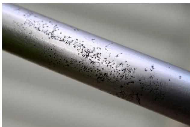
**Figura 2:** Corrosão por sulfatos (Pitting).
