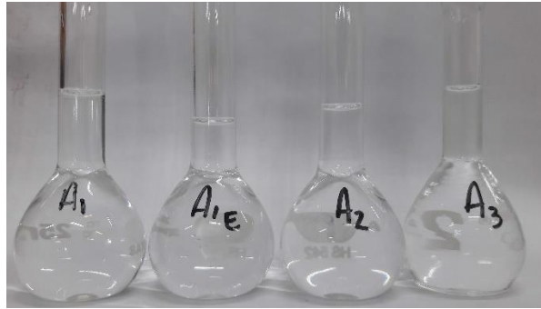
Figura 3: Representação da diluição das amostras para determinação do FPS das amostras de protetor solar.
