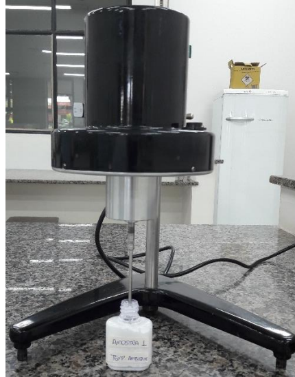
Figura 1: Determinação da viscosidade aparente das amostras de protetor solar.
