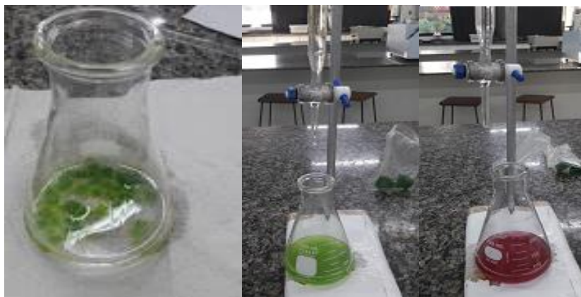
Figura 18 - Determinação do Índice de Acidez dos Sabonetes de Glicerina contendo Extrato Glicólico de Arnica
