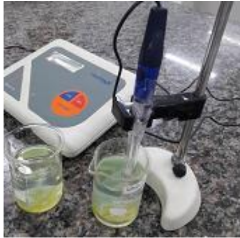
Figura 13 - Determinação do pH dos Sabonetes de Glicerina com Extrato Glicólico de Arnica
