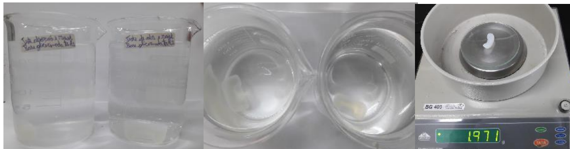
Figura 5 - Demonstração do Teste de Absorção e Resistência à água
