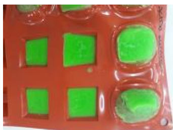
Figura 8 - Demonstração da quebra da formulação de sabonete de glicerina com ácido glicólico incorporado.
