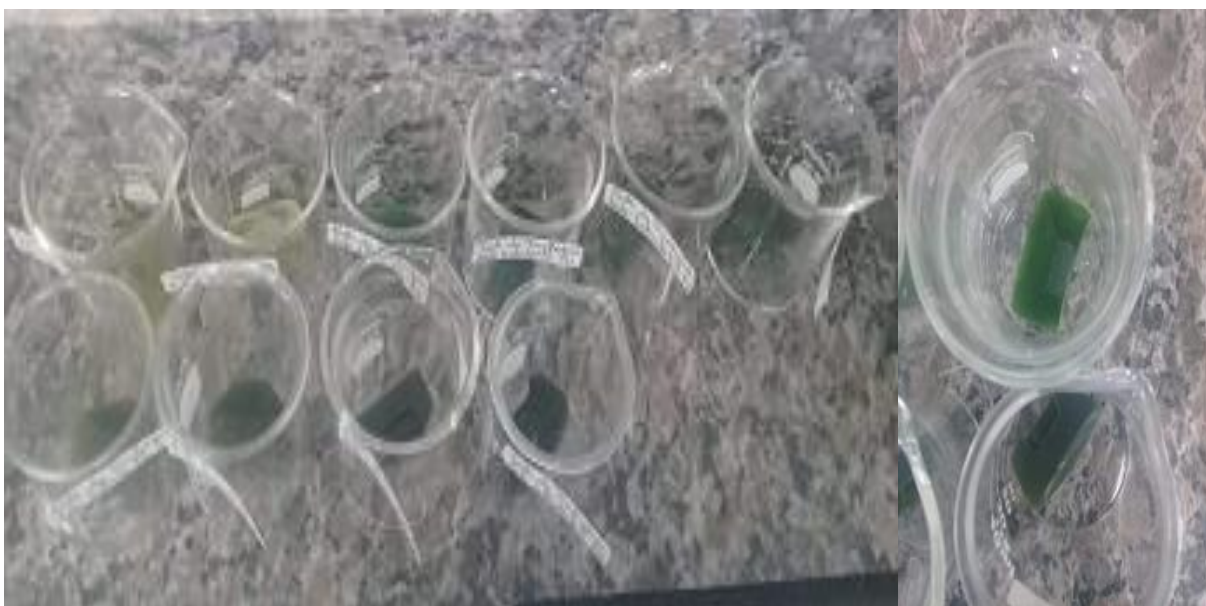
Figura 15 - Demonstração do Teste de Rachadura dos Sabonetes de Glicerina contendo Extrato Glicólico de Arnica
