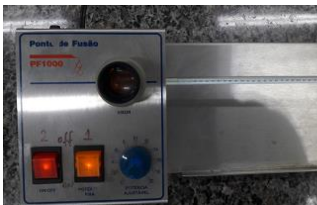
Figura 19 - Determinação do Ponto de Fusão dos Sabonetes de Glicerina contendo Extrato Glicólico de Arnica
