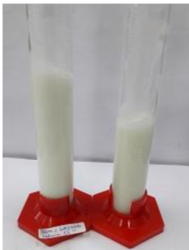
Figura 14 - Representação do teste de Altura e Estabilidade de Espuma
