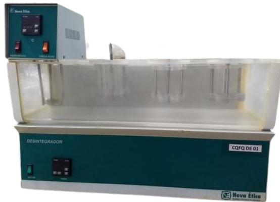
Figura 4. Desintegrador utilizado para a realização do teste.
