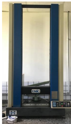
Figura 6 - Máquina de Ensaio Universal (EMIC DL-3000 – Capacidade de 30 kN).
