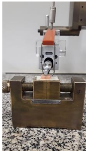
Figura 5. Medição da rugosidade superficial.
