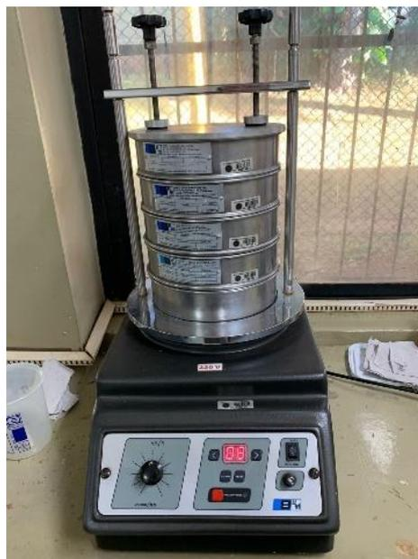
**Figura 27** - Agitador eletromagnético da Tecnal<sup>®</sup>, modelo B-AGIT Ber tel.
