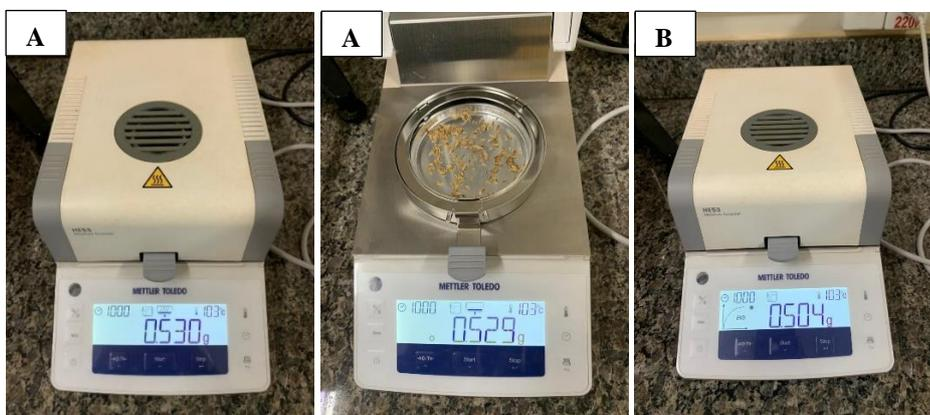
**Figura 14** – Equipamento de medição de teor umidade da Mettler Toledo® (HE 53). A) Pesagem Inicial; B) Pesagem Final.
