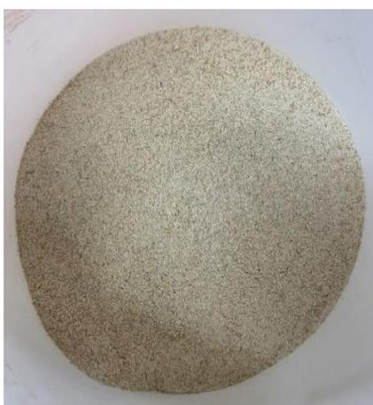
**Figura 18** – Pó proveniente pó e palha de malte obtido após a moagem.
