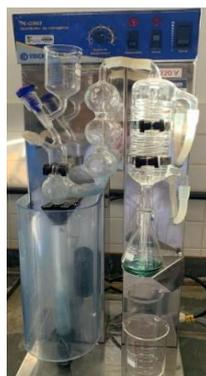
**Figura 22** – Destilador de Nitrogênio Total da Tecnal<sup>®</sup>, (TE-0363), utilizando Método de Kjeldahl.
