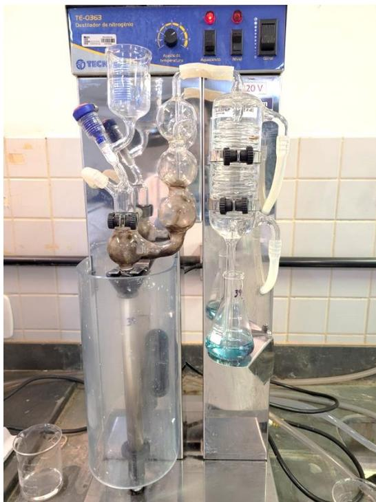
Figura 19: Destilador de nitrogênio Tecnal TE-0363<sup>®</sup>
