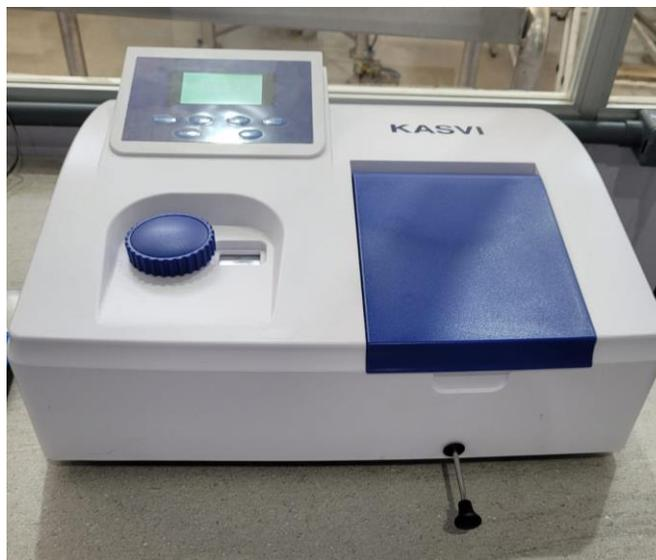
Figura 17: Espectrofotômetro Kasvi®
