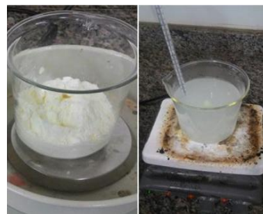
Figura 1: Gelatinização do amido de milho
