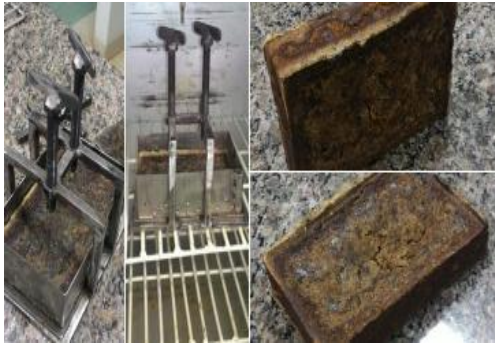
Figura 4: Característica do painel após prensagem, secagem e resfriamento.
