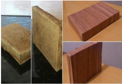
Figura 5: Painel após lixamento da chapa e acabamento
