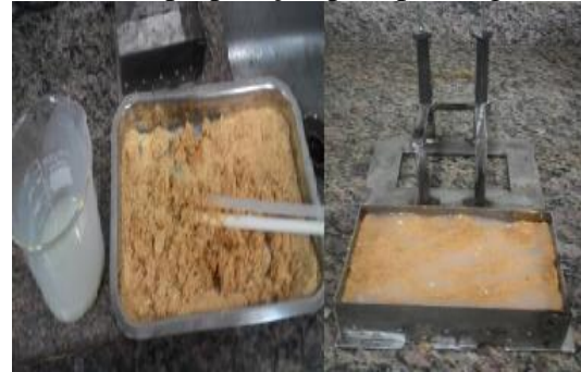
Figura 2: Mistura de fibra resina de adesão e preparação para prensagem.
