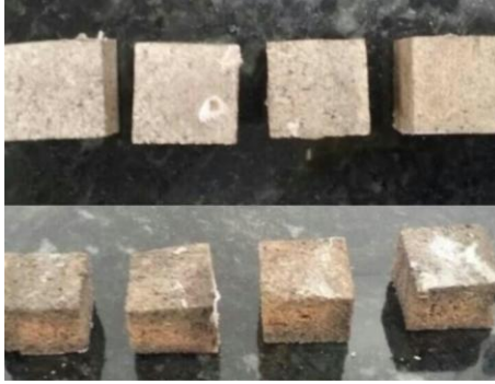
Figura 6: Análise de Inchamento (antes e depois de imersão em água).
