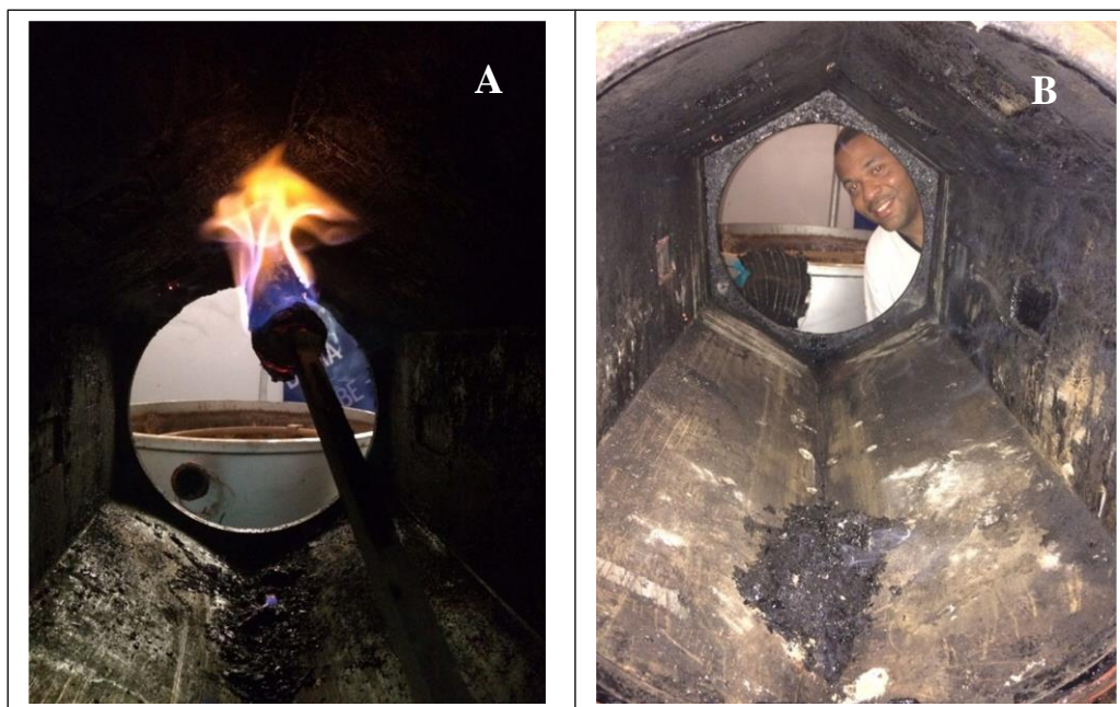
Figura 3.3 - Limpeza do micro-ondas, através do aquecimento (A) seguido de raspagem e eliminação de impurezas (B).
