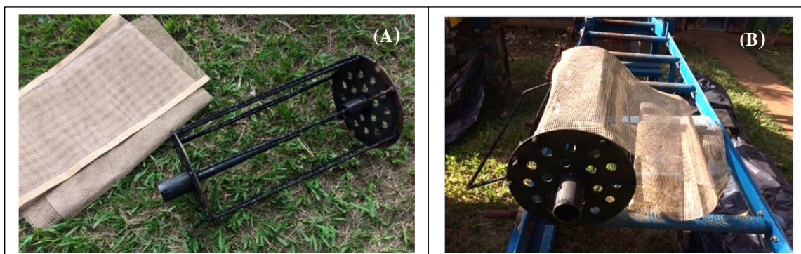
Figura 3.5 - Tela de fibra de vidro resistente a temperatura 600°C (A): revestimento do cesto com fibra de vidro (B). Fonte: Autor (2018).
