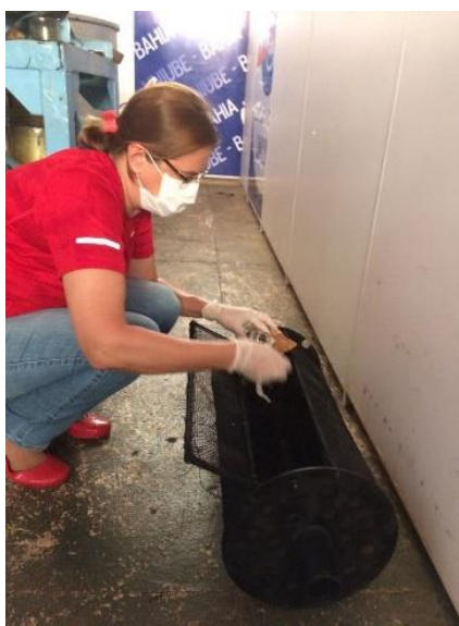
Figura 3.12 – Coleta fora do forno, do lodo tratado pelas micro-ondas, para análise microbiana. Fonte: Autor (2018).
