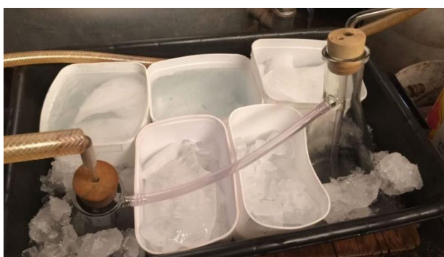
Figura 3.8 - Coleta de gases não condensáveis (GNC). Fonte: Autor (2018).
