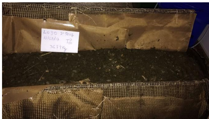
Figura 3.6 - Detalhe do cesto revestido pela tela e papel resistente a 600° C. Fonte: Autor (2018).
