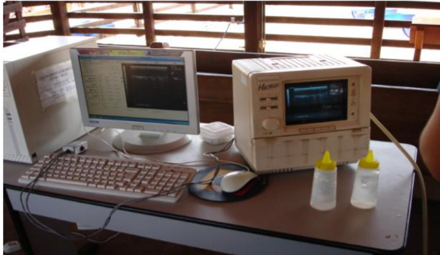
FIGURA 1 – Equipamento utilizado na ultrassonografia para obtenção da AOL, EGS e marmoreio.
