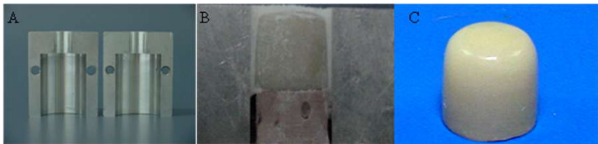
Figura 16- Aplicação e queima das cerâmicas de cobertura. A. Dispositivo metálico bipartido, B. Coping posicionado no dispositivo metálico bipartido com cerâmica de cobertura aplicada e C. Aspecto final após aplicação e queima da cerâmica.
