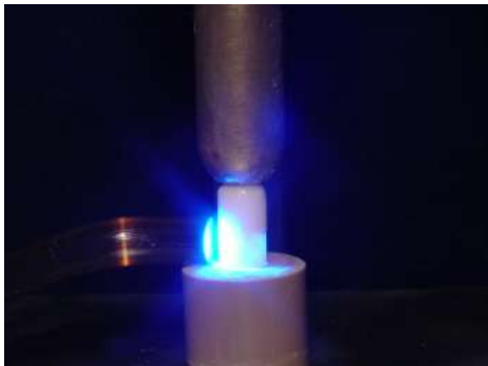
Figura 26- Fotopolimerização do cimento
