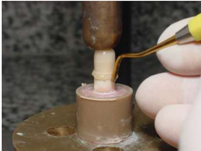
Figura 25- Aplicação da carga e remoção do excesso de cimento
