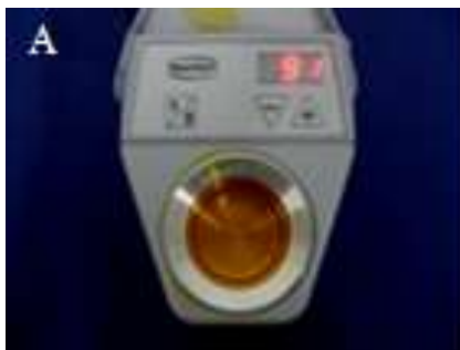
Figura 7- Preparo dos padrões em cera. A. Aparelho de imersão e B. Padrão de cera sobre o troquel.
