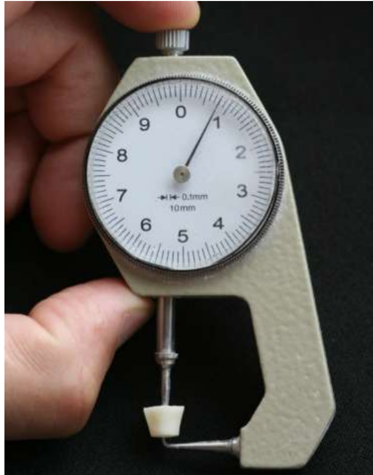
Figura 15- Dimensão final dos copings
