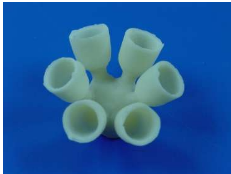
Figura 10- Copings desincludidos por jateamento com esferas de vidro de 80 \mu\text{m}
