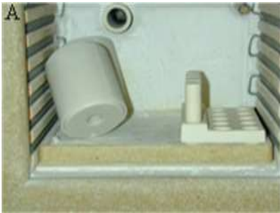
Figura 9- A. Anel no forno para eliminação de cera e B. Cilindros de revestimento transferidos para o forno de pressão
