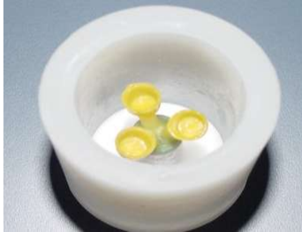
Figura 8- Padrões em cera posicionados no anel de revestimento.
