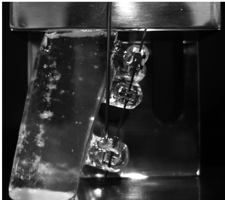
Figura 16 – Detalhe do encaixe entre o gancho do arco de retração e o arco de ligação ligado à máquina de ensaios universais.
