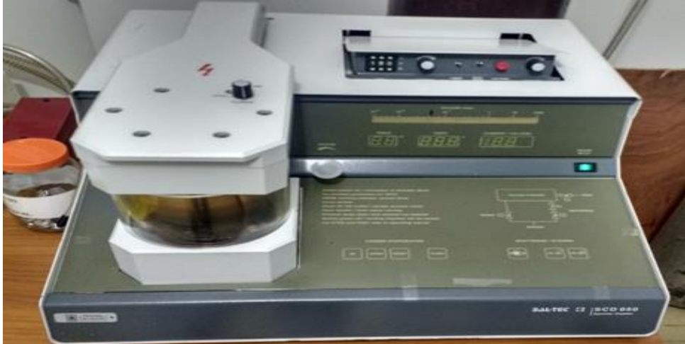
Figura 14. Metalizador Sputter Coater para recobrimento com ouro para análise em MEV
