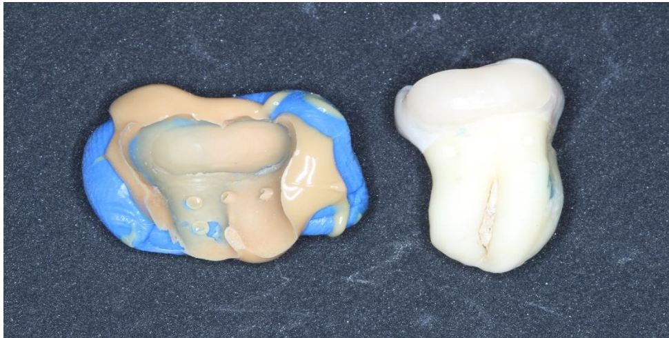
Figura 11. Molde pronto para colocação da resina epóxi
