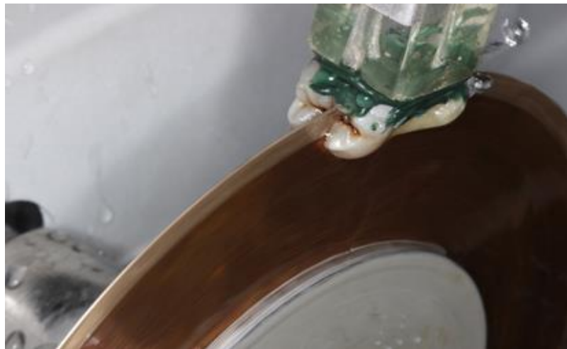
Figura 5. Seccionamento dos dentes (ISOMET 1000, Buehler)
