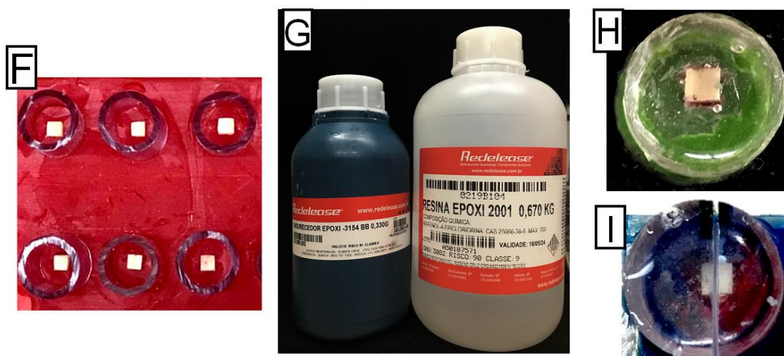
Figura 5: F: Tubos de plástico em cera, com espécime acoplados lado a lado. G: Resina Epóxi com endurecedor. H: Espécime no interior da esfera de resina. I: Corte dividindo área experimental e área controle.
